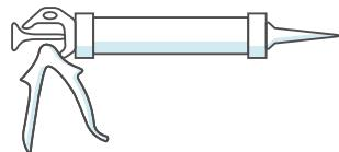
Файл-пакет надрезается с одной из сторон и помещается в пистолет.
