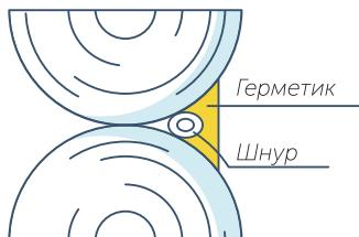
Толщина герметика  $\geq$  4-10 мм.
